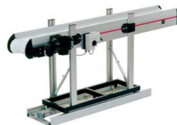
Struttura di supporto con avanzamento rettilineo
