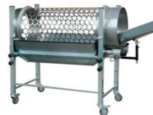
Separatore a tamburo forato con struttura di supporto rinforzata
