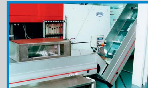
Un sistema chiuso: Il passaggio del manufatto stampato dalla pressa a iniezione sui nastri MTF.
