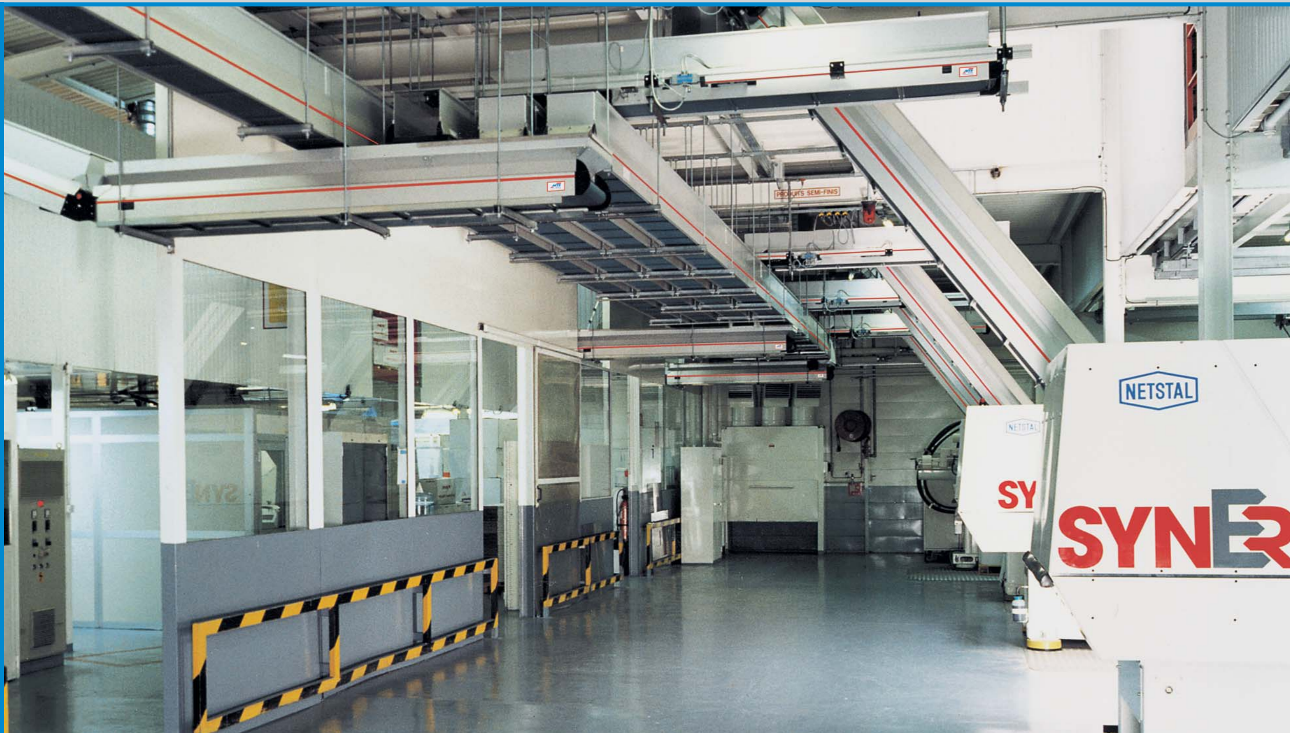
Automazione gestita da computer tra pressa a iniezione e macchina di stampa: i pezzi stampati a iniezione vengono distribuiti sui nastri trasportatori inclinati MTF a regolazione pneumatica.
