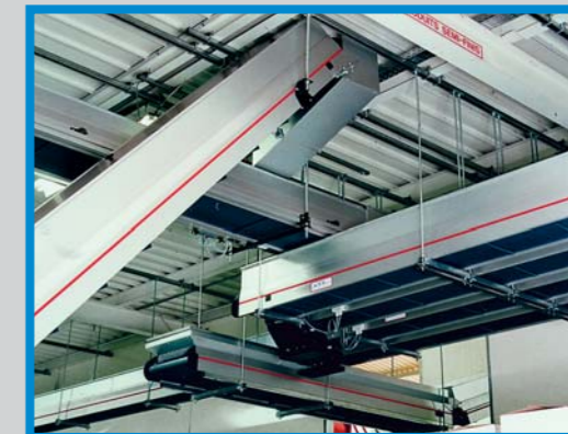
Automazione gestita da computer tra pressa a iniezione e macchina di stampa: i pezzi stampati a iniezione vengono distribuiti sui nastri trasportatori inclinati MTF a regolazione pneumatica.
