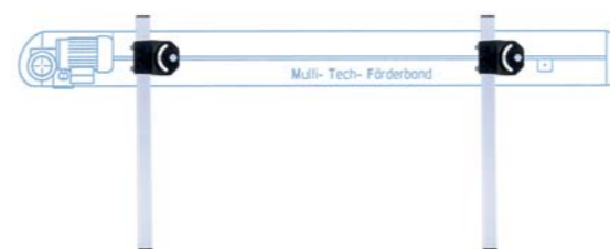
AM 140 , stabile, sostegno unico regolabile in altezza, ottima adattabilità a diversi livelli, scale o vani macchina.
