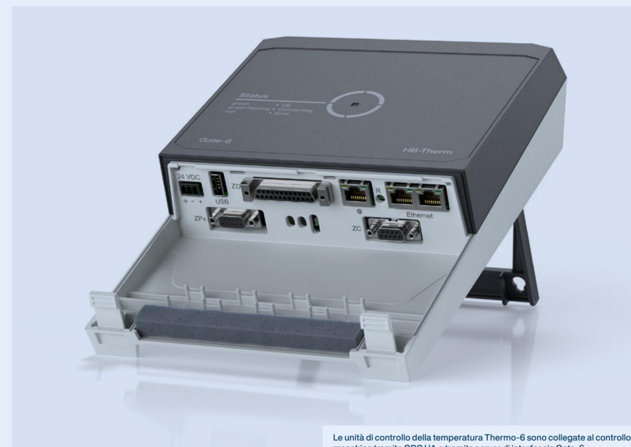
Le unità di controllo della temperatura Thermo-6 sono collegate al controllo macchina tramite OPC UA o tramite server di interfaccia Gate-6.
