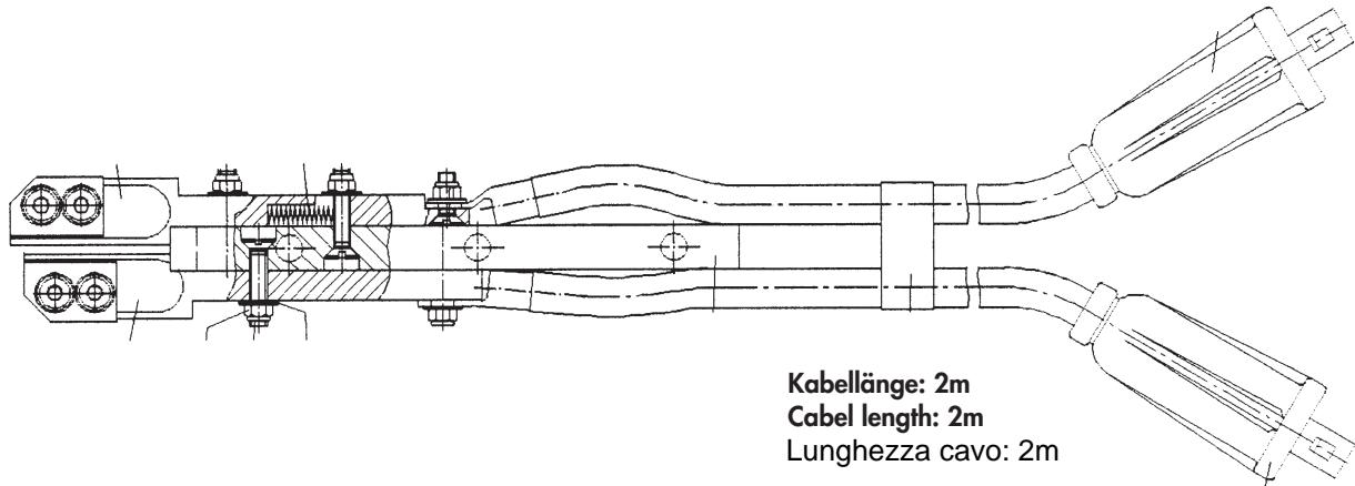
Grundplatte des **Thermoschneidegriffs ZTS 25** mit Befestigungsbohrungen /
