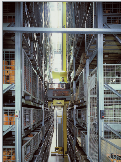
Il moderno magazzino automatico a scaffalature alte rende rapidamente disponibili pezzi di ricambio e soggetti a usura.
