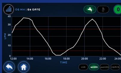
I dati sono immagazzinati nella memoria interna e possono essere visualizzati in forma grafica per ogni singolo circuito. I dati possono anche essere esportati per uso esterno.
