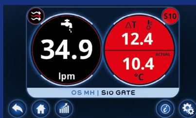
Cliccando su uno specifico circuito si possono vedere informazioni dettagliate, incluso delta T (transfer termico) dello specifico canale. E' incluso anche l'indicatore di flusso turbolento.
